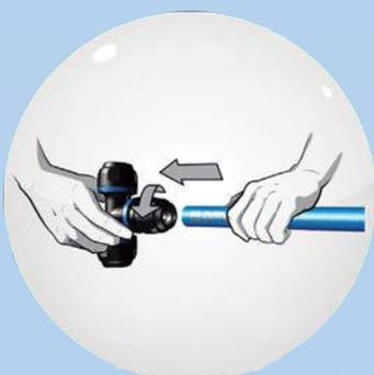
Svitare il dado di qualche giro, quindi inserire il tubo facendolo ruotare leggermente per raggiungere la corretta profondità di inserimento nel raccordo. NB: si raccomanda di utilizzare un fluido di montaggio (cod. PPS AL) per facilitare l'inserimento dei tubi nei raccordi.
