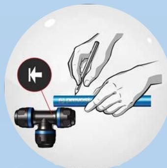
Tracciare un segno sul tubo per indicare la lunghezza di inserimento nel raccordo (utilizzare le tacche sui raccordi o sulla chiave di serraggio).
