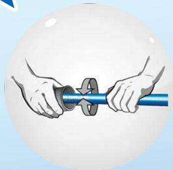
Smussare l'esterno del tubo per facilitare l'inserimento ed evitare di danneggiare la guarnizione. Un leggero smusso interno permette di eliminare gli eventuali residui di taglio. (Per i diametri pari a 63 e 80 mm, utilizzare un attrezzo specifico per il taglio e lo smusso, cod. PPS CTCHE6380).
